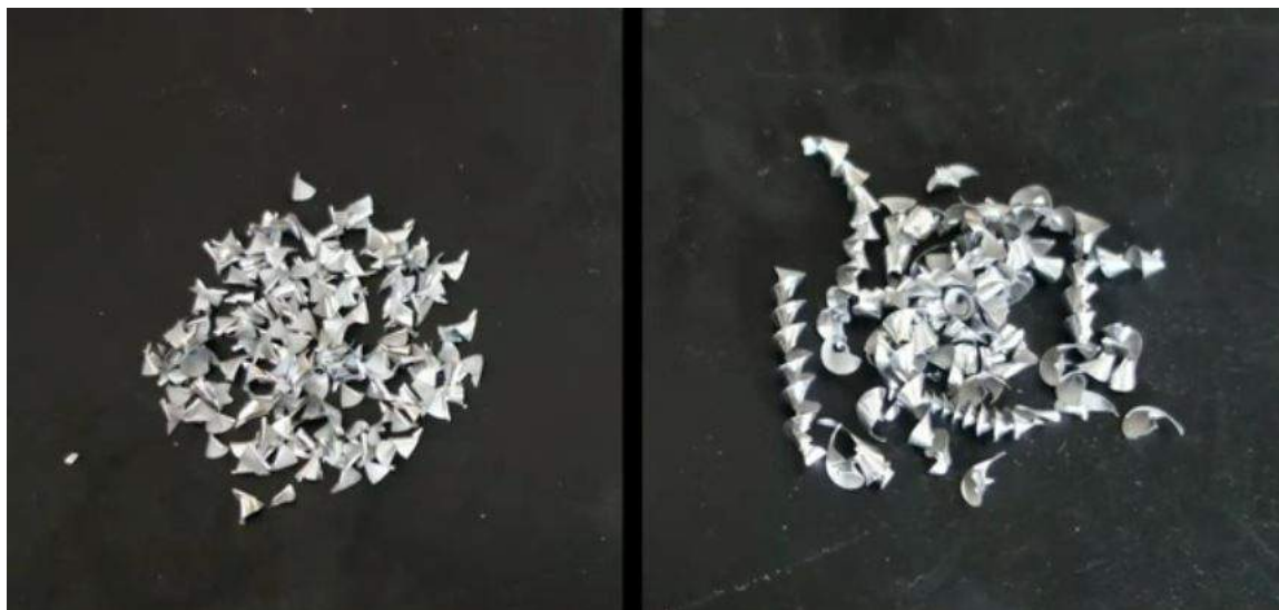
Рис. 9. Стружка при «клюющей» (слева) и постоянной подаче (справа)
