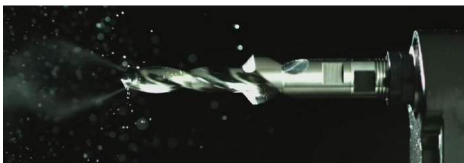
Рис. 10. Воздушно-смазочная смесь (MQL)
