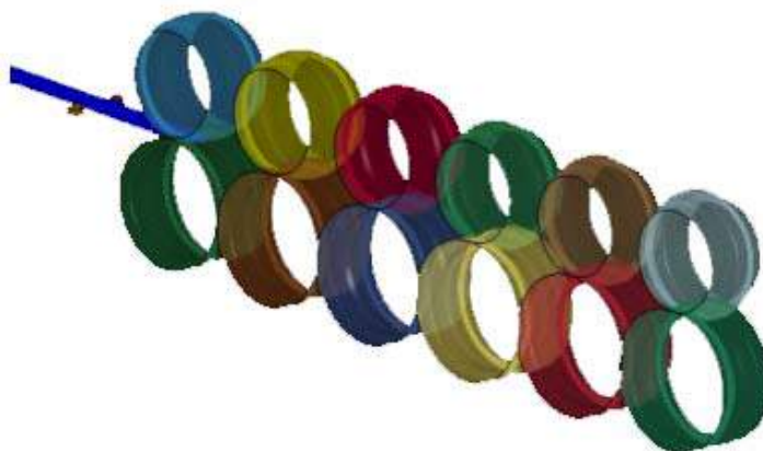
Рис. 5. Моделирование процесса формообразования гнутого профиля корытообразного типа
