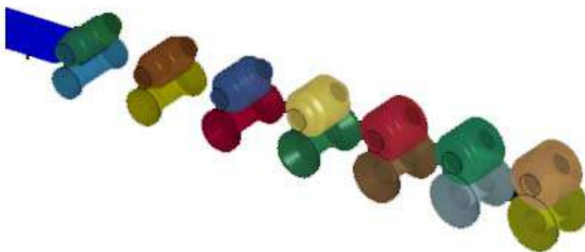
Рис. 4. Моделирование процесса формообразования гнутого профиля швеллерообразного типа
