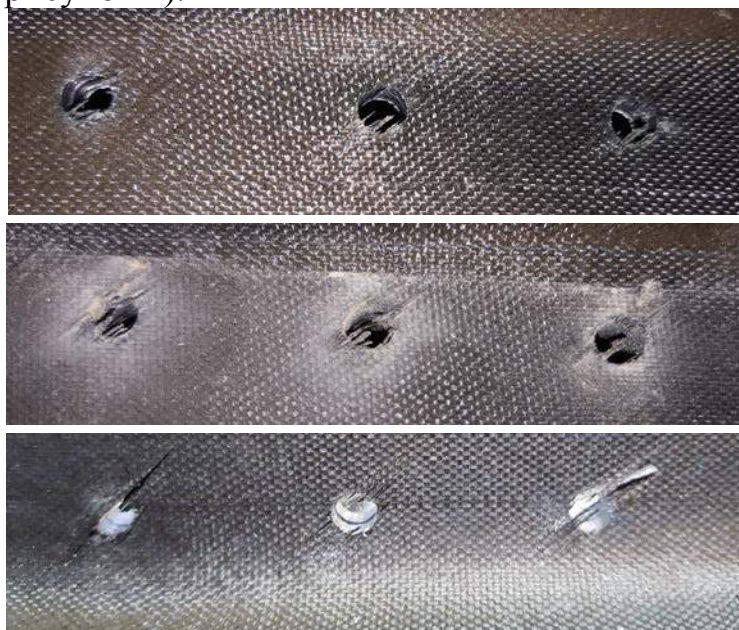
Рис. 1. Расслоения в местах выхода режущего инструмента
