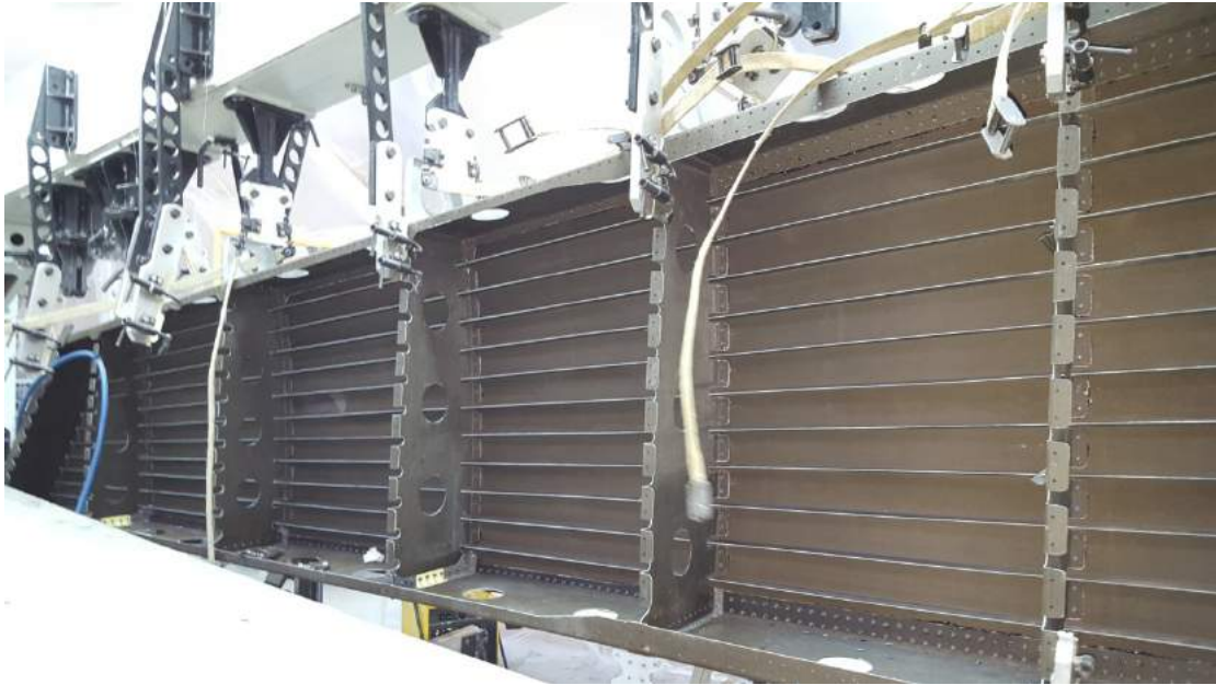
Рис. 2. Кессон кия современного ЛА (внутренняя часть)
