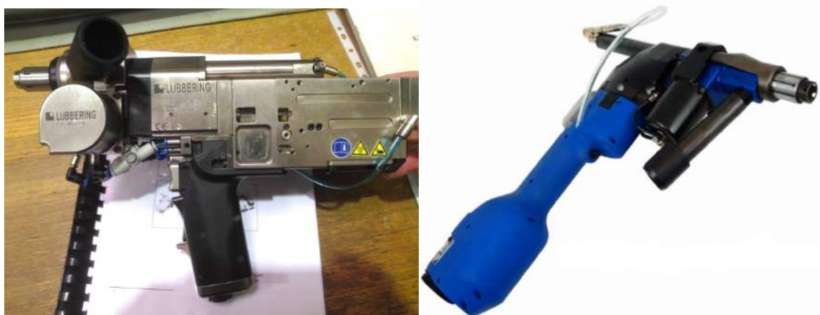
Рис. 6. СМАП пневматическая ф.Lubbering (слева) и электрическая ф.Seti-Тес (справа)
