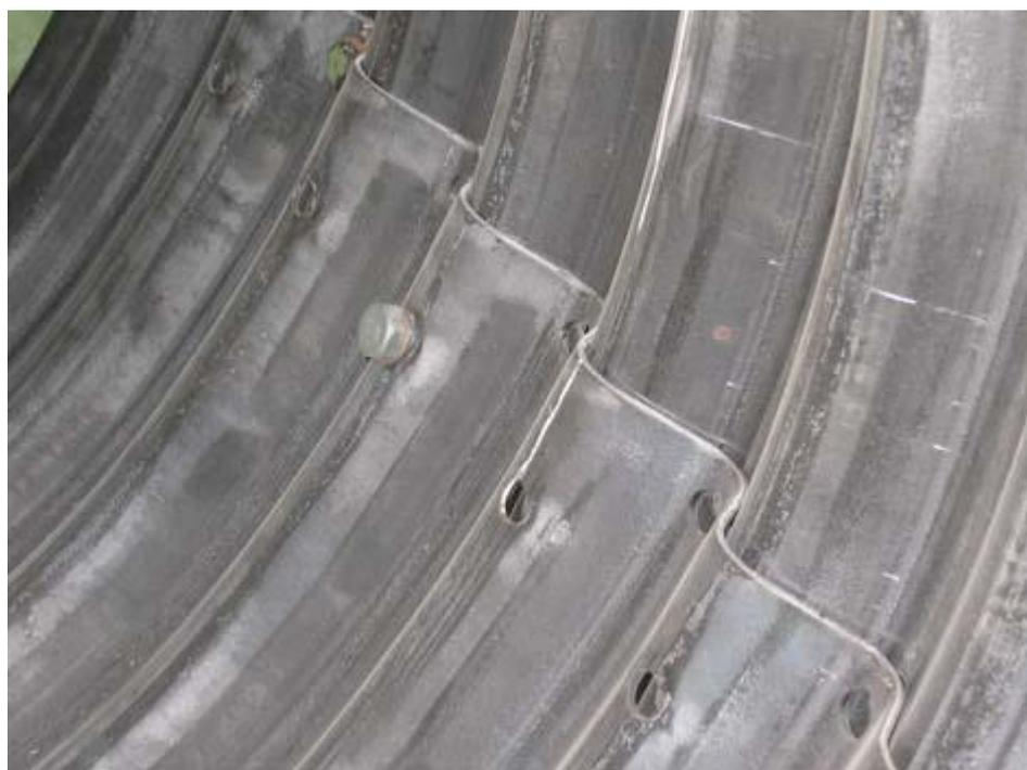
Одновременно конструктивные особенности гибочной машины, позволяют получить заготовки с любым (в том числе с переменным) продольным радиусом от 1 до 60 м и более. Деформация отверстий для сборки в гофрированном листе минимальна.
