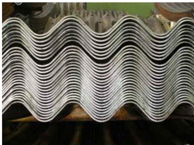
Разработанная технология гибки, калибровки, перфорации и формовки обеспечивают высокоточную собираемость элементов в гофрированную трубу без применения «силовой сборки». Линия внедрена и успешно эксплуатируется на предприятии ОАО «Алексинстройконструкция», директор Шуляков А. В., гл. инженер Лаконцев В. Н.
