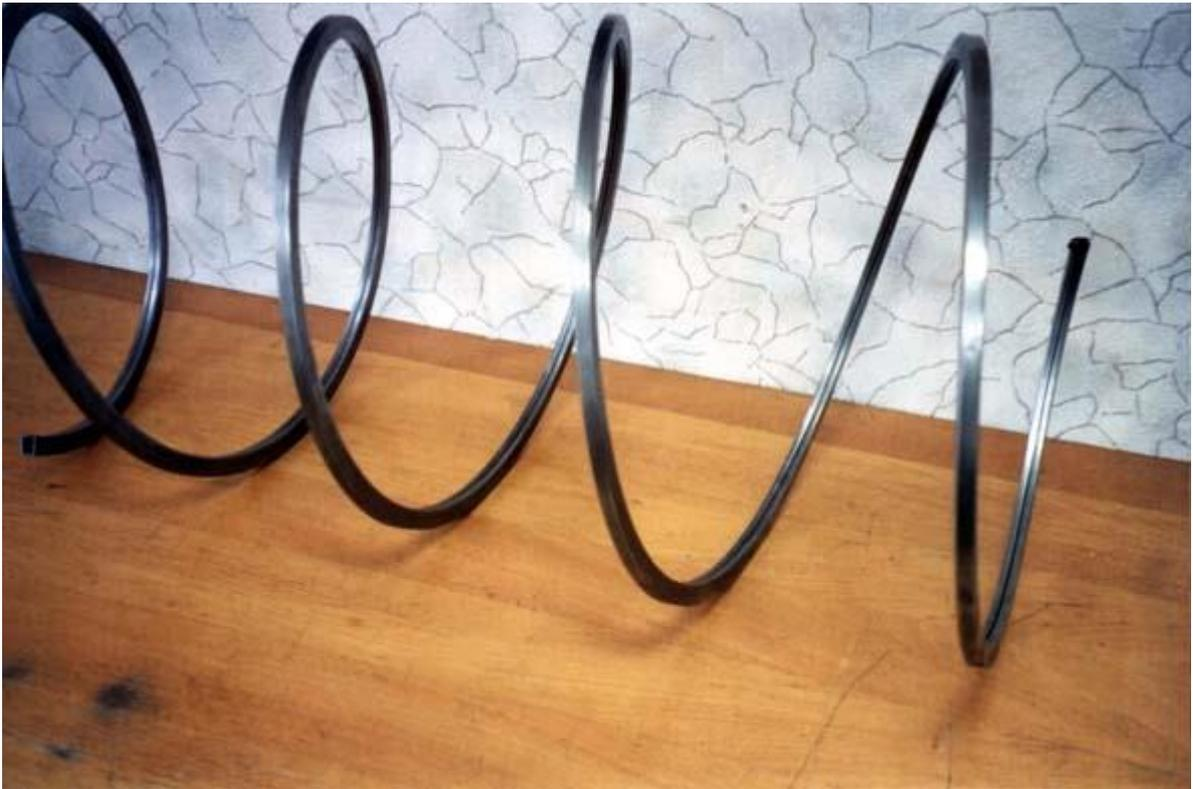
Минимальный радиус кривизны, получаемый данным методом, рассчитывается по каждому профилю и может достигать  $25-50H$  (где  $H$  – высота профиля).
